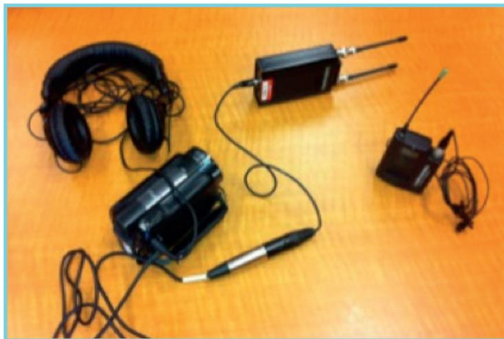
Pour mettre en marche le micro sans fil, appuyez sur les deux boutons *Power* de l'émetteur (situé sur le dessus, sous un bouton coulissant) et du récepteur (situé entre les deux antennes) pendant deux à trois secondes. Des chiffres de canaux apparaissent sur l'émetteur et une lumière verte s'allume.
